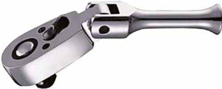
Gelenk-Umschaltknarre, kurze Ausführung, Knarr-Rad: 48 Zähne, Umschalthebel, Druckknopfauflösung
