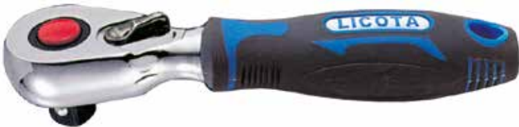
Umschaltknarre, kurze Ausführung, Knarr-Rad: 48 Zähne, Umschalthebel, Druckknopfauflösung, rutschfester 2-Komponenten-Griff mit Aufhängeloch
