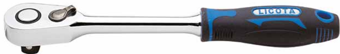
Umschaltknarre, Knarr-Rad: 60 Zähne, Umschalthebel, Druckknopfauflösung, rutschfester 2-Komponenten-Griff mit Aufhängeloch
