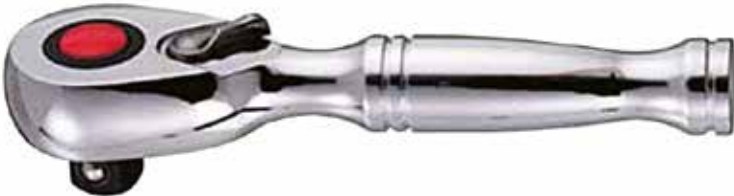
Umschaltknarre, kurze Ausführung, Knarr-Rad: 48 Zähne, Umschalthebel, Druckknopfauflösung
